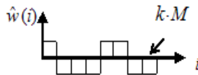
Рис. 3. Преобразованный случайный бинарный код \hat{w}(i) = \pm 1 длины k \cdot M = 8 , представляющий ЦВЗ
